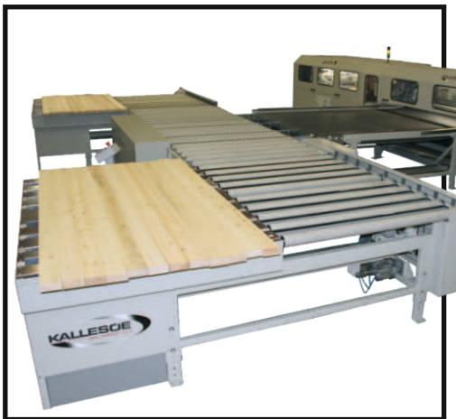
Sortieranlage KS1 doppelte Sortieranlage für das manuelle Sortieren der Lamellen
