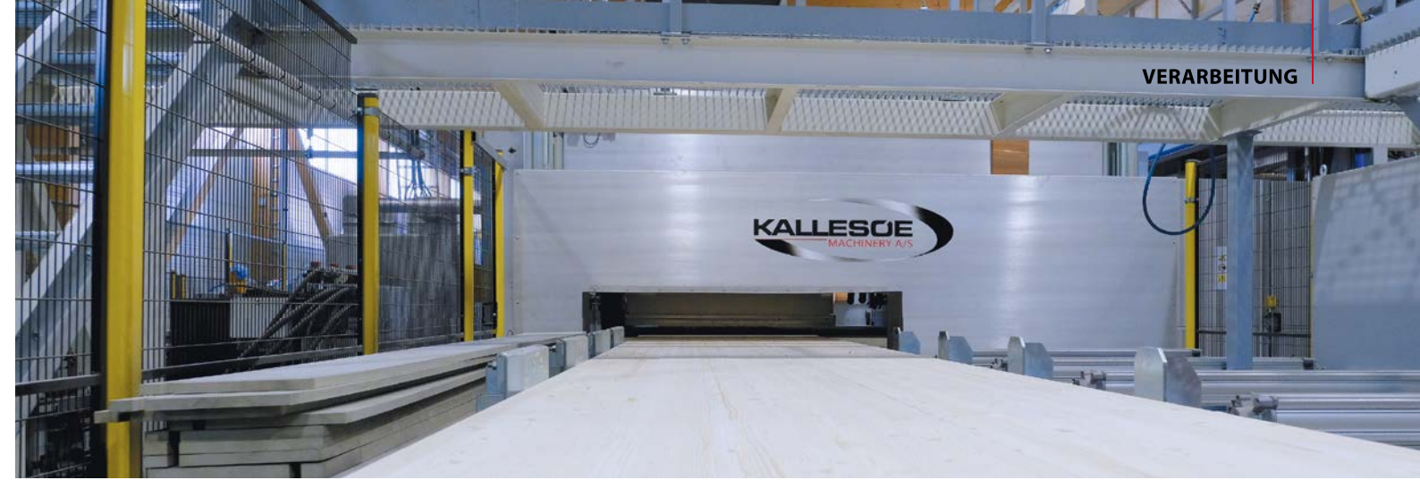
Presse: Die Vario-Press von Kallesoe verleimt mit Hochfrequenz. Sie kann verschiedene Längen im selben Presszyklus verarbeiten
